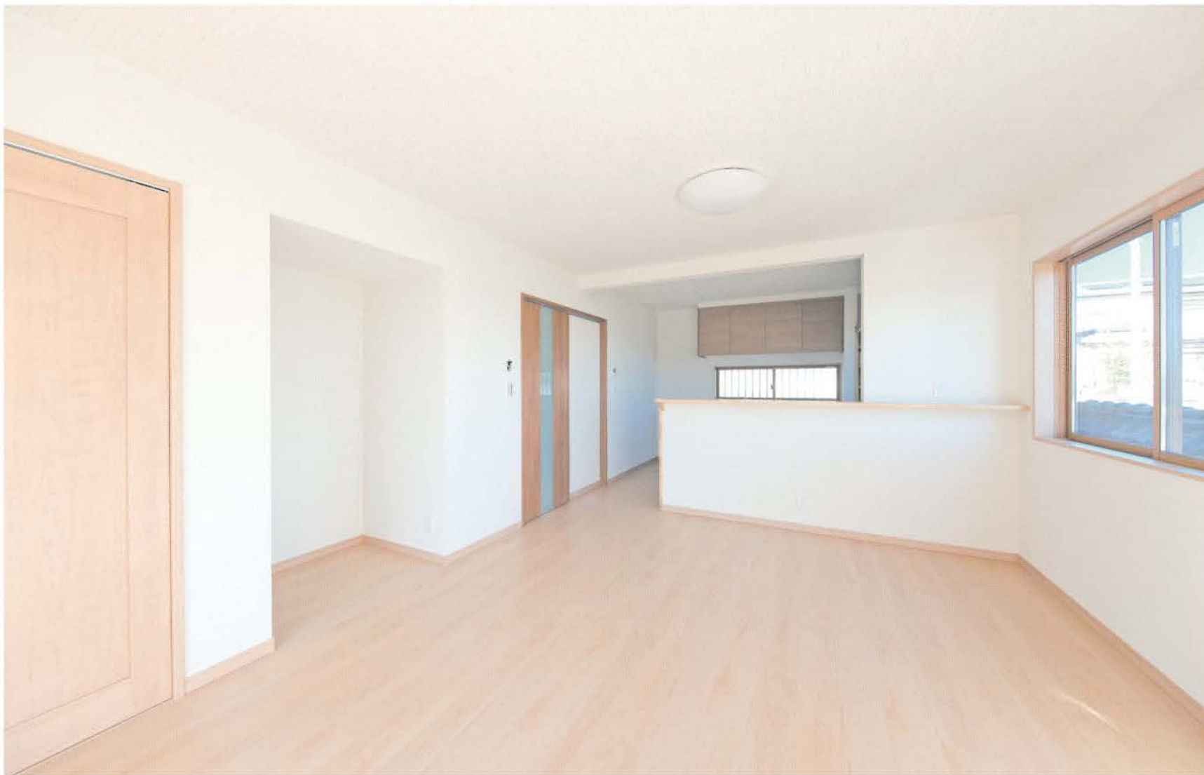
明るく開放的なリビング空間。天井にはノイズを吸収して音が共鳴せず、会話がクリアに聞こえる調湿吸音材を張った
