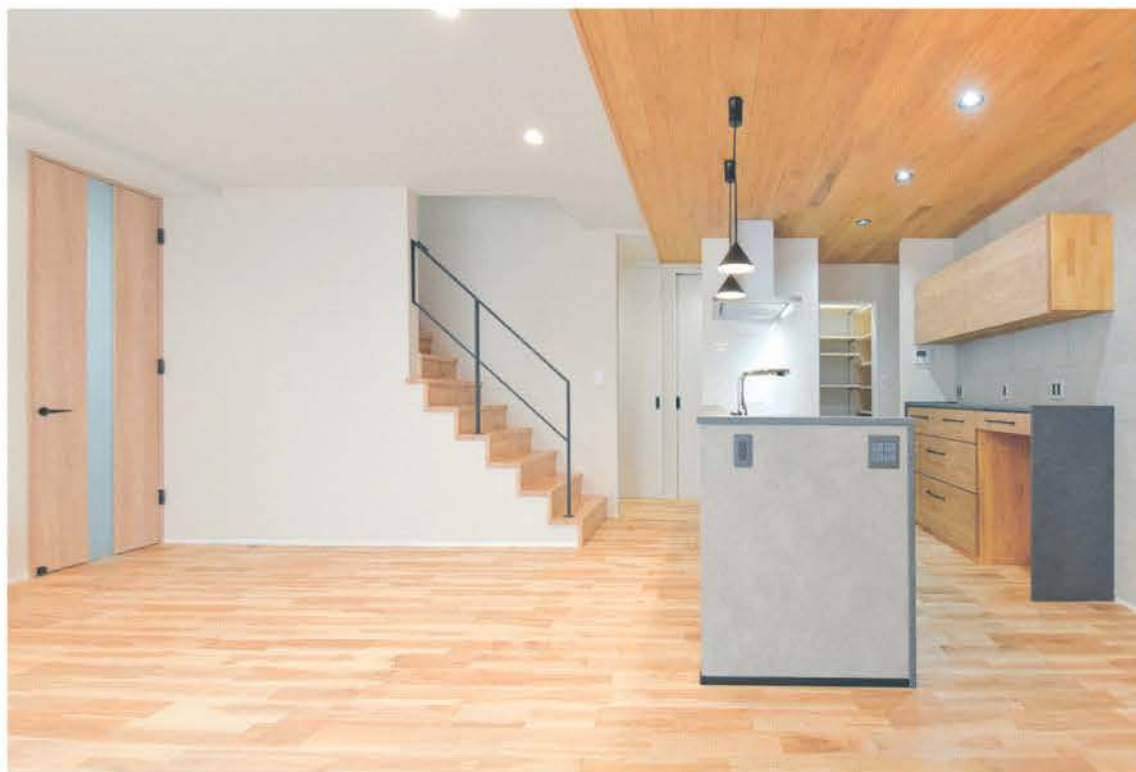
1階だけで生活が成り立つ間取りの家。床や天井に無垢の板を張ったLDKで、棚・建具などは全て職人の手による造作。キッチンの裏に風呂、洗面脱衣室、物干し室など水回りが全て集合して回遊でき、家事効率が良い。
